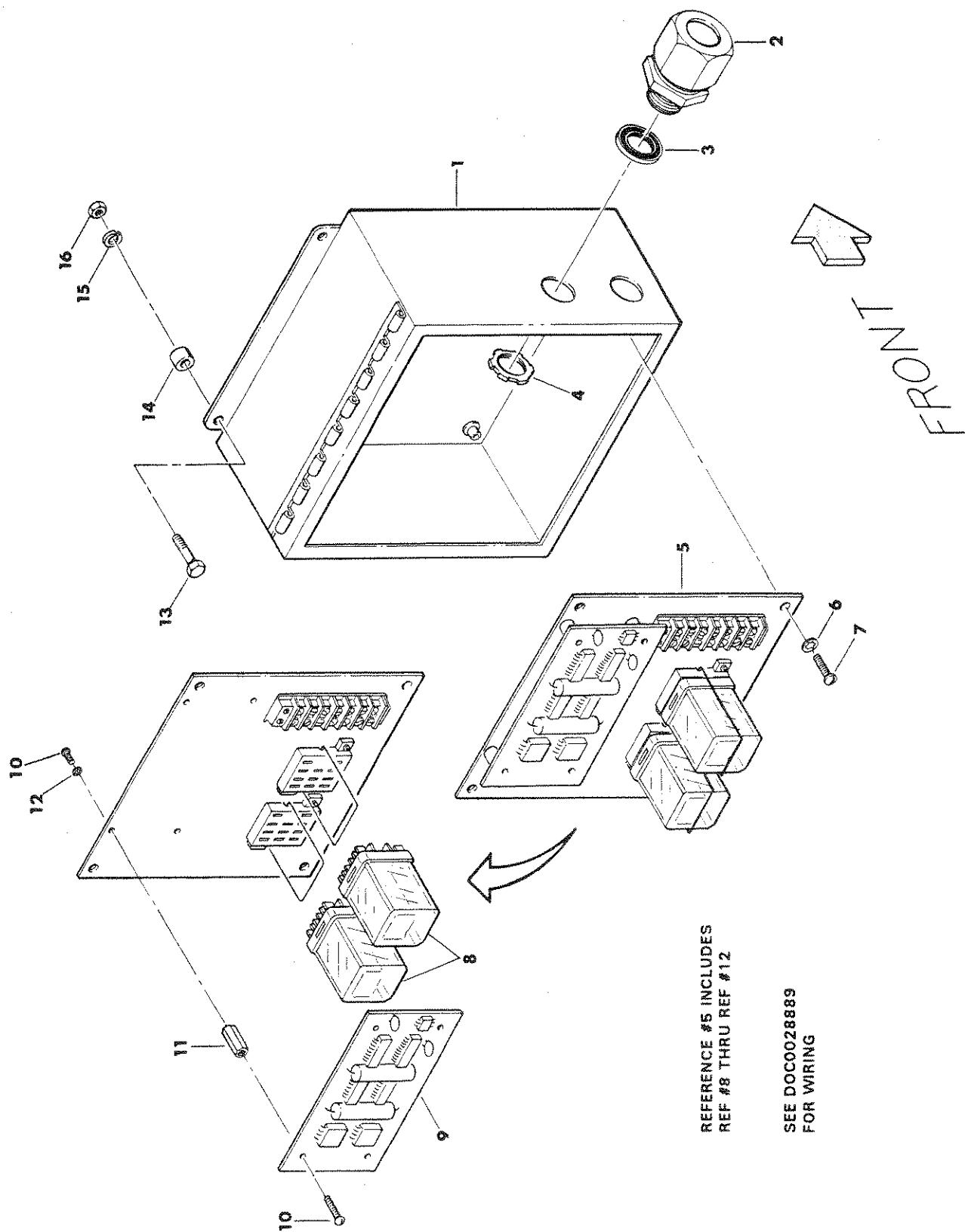
**FAN CONTROL BOX AND PANEL ASSEMBLY**
