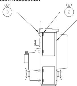
NOTE: SOME UNITS UTILIZE THE MOUNTING SURFACE ON THIS SIDE OF THE TRANSMISSION REF DRIVETRAIN / DRIVELINE INSTL. DRAWINGS.
